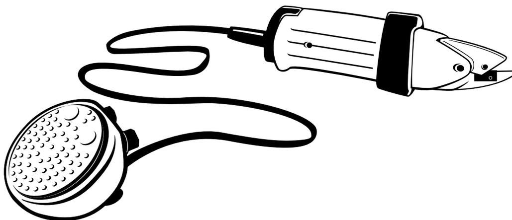
Para seleccionar, gire la perilla hacia la posición de modo **Segundos Temporizados (S)**, y la perilla del temporizador hacia la cantidad de segundos que usted quiere que el aparato se mantenga prendido. Cuando se acaban los segundos, el Select Switch le apagará al aparato automáticamente, aunque el usuario sigue oprimiéndole al interruptor.
